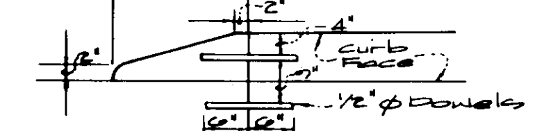
Noose Down Curb Detail N.T.S.
