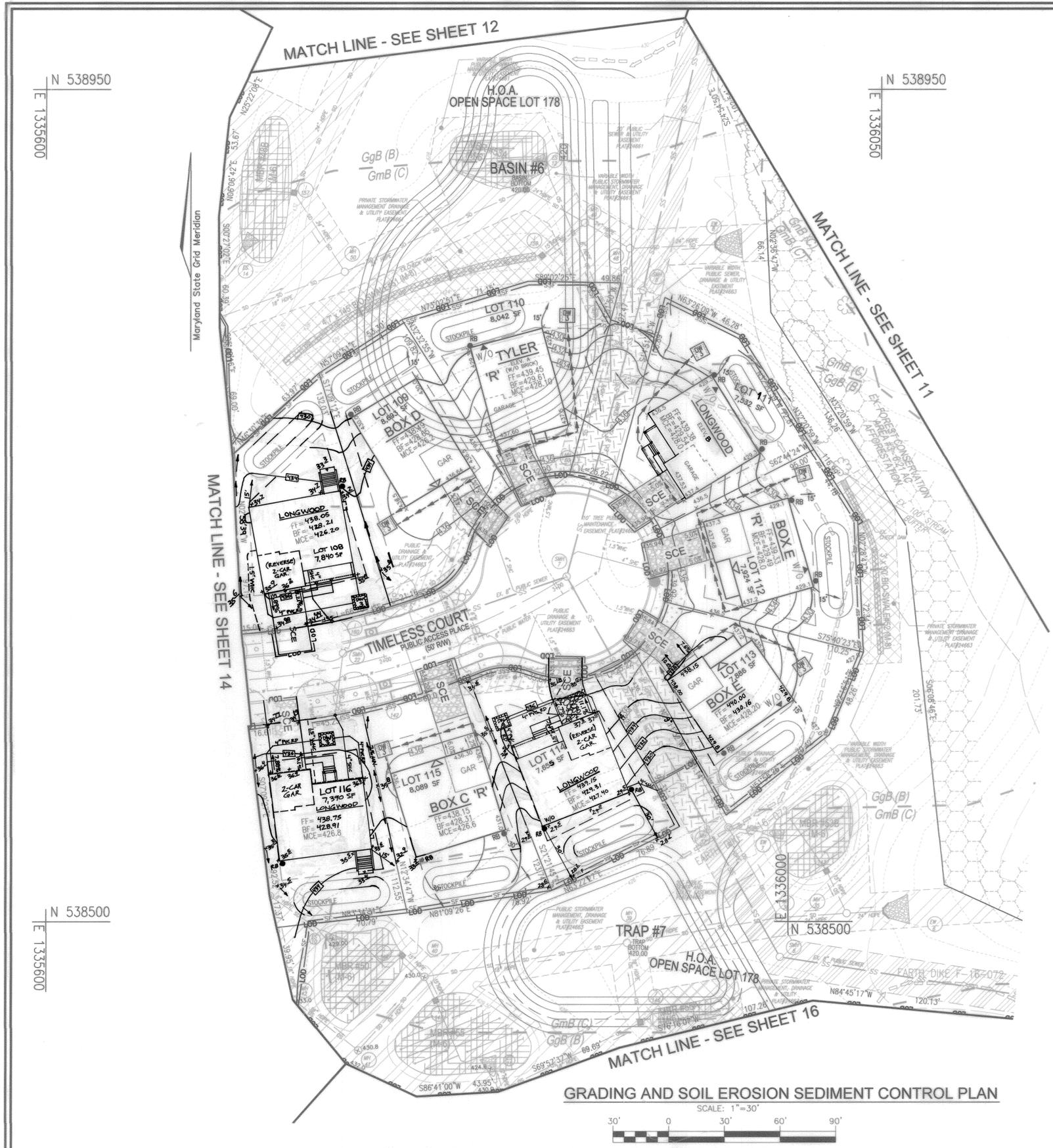
GRADING AND SOIL EROSION SEDIMENT CONTROL PLAN
