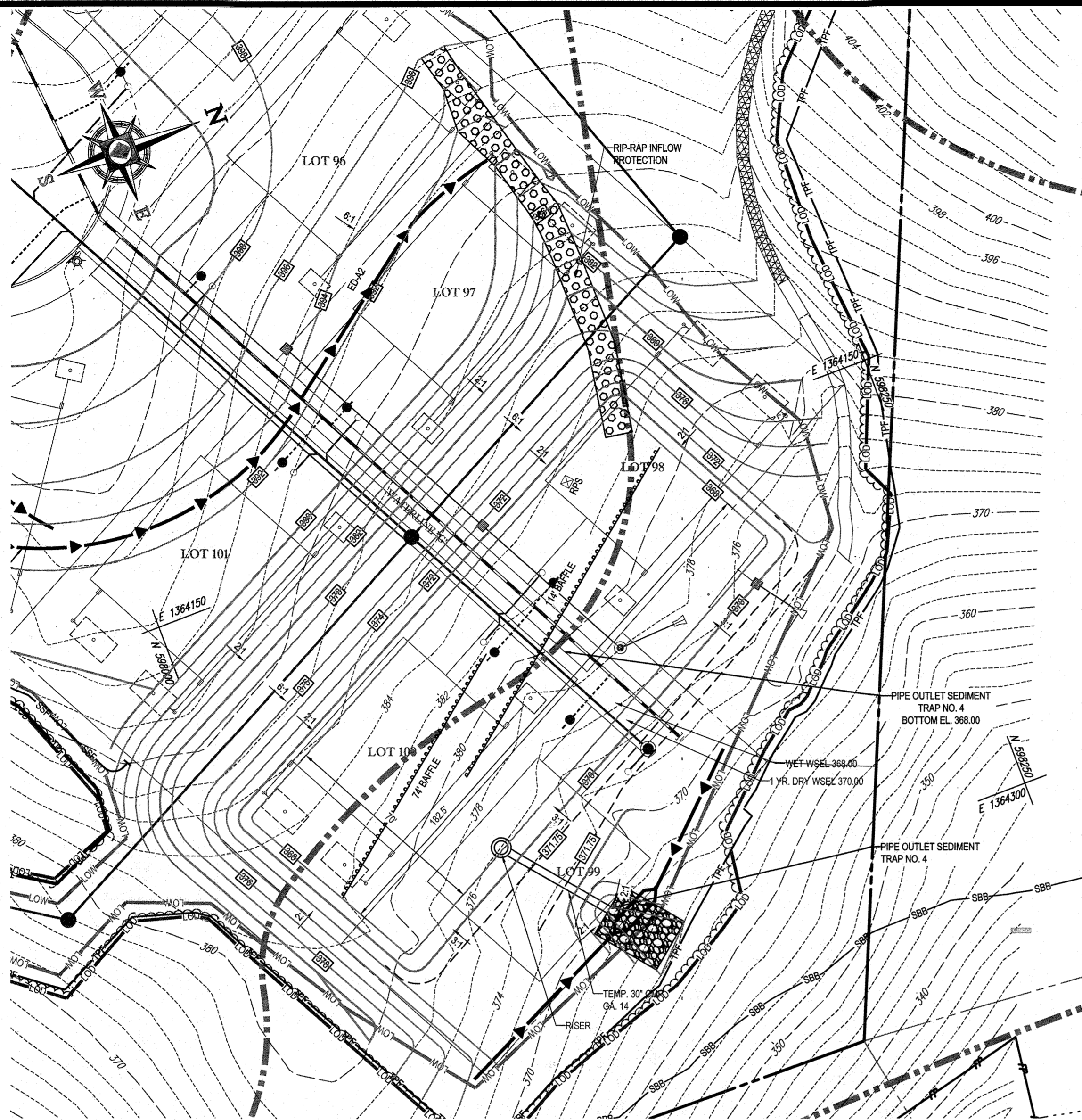
PIPE OUTLET SEDIMENT TRAP NO. 4 SCALE: 1"=30'
